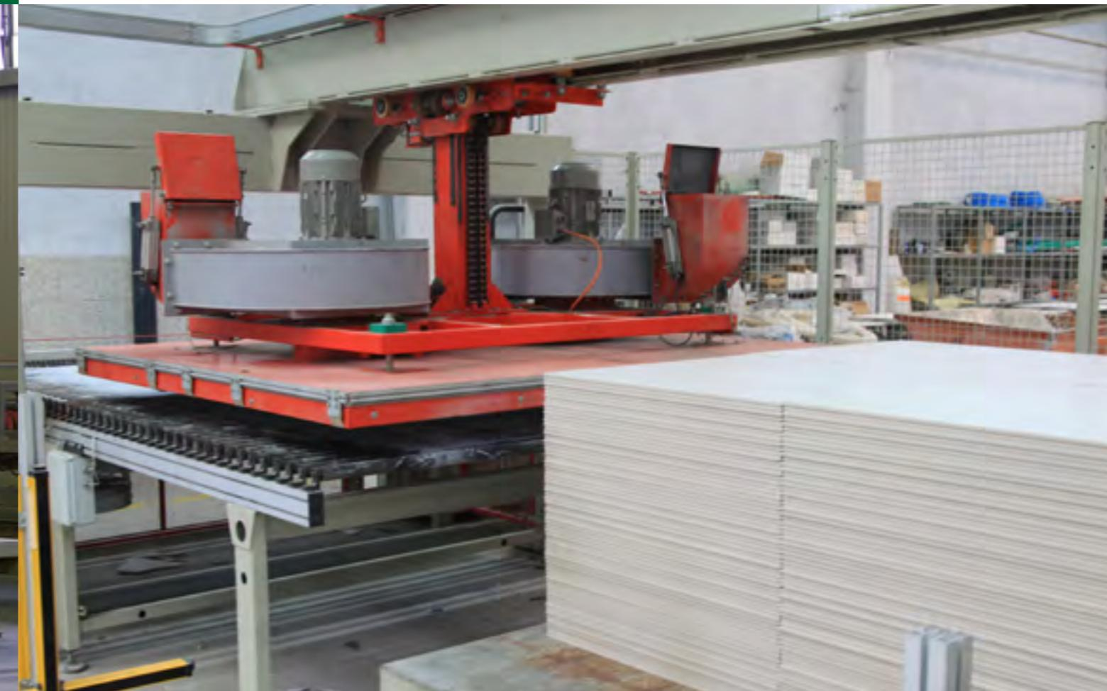
A **BT982** permite a formação dos planos de produto cozido e o empilhamento em vários níveis sobre plataformas mediante pinça com plano aspirante. O produto cozido será posteriormente alimentado à escolha com uma máquina de descarga apropriada.
